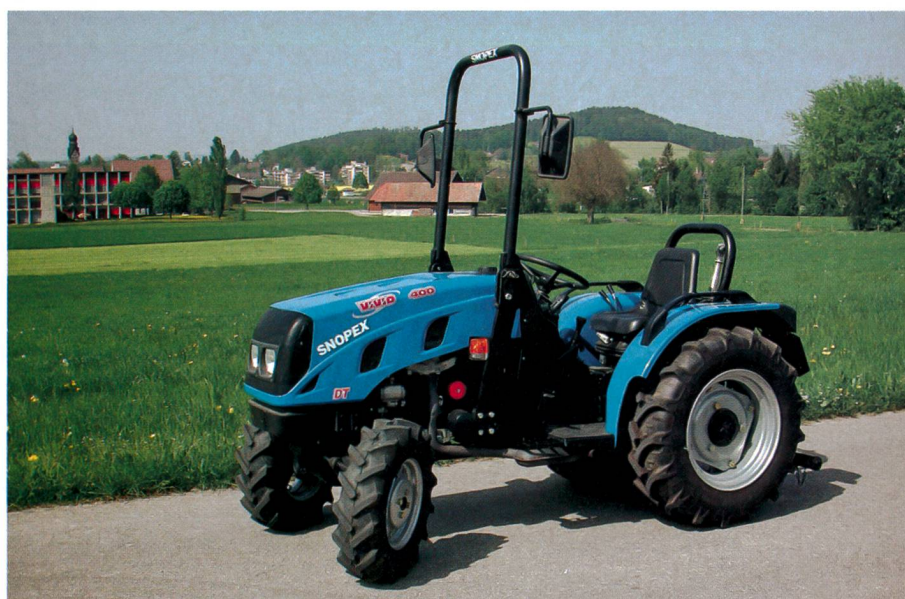
Tracteur BCS Vivid 400 DT, moteur à aspiration 4 cylindres avec 25,5 kW (35 CV), transmission réversible non synchronisée, poids 960 kg (prix catalogue CHF 29907.-), rapport de test n° 1857/03.
