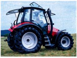
gement doux du sens de marche, quadruple prise de force (540/750/1000/1400 tr/min), puissante installation hydraulique, commande automatique de différentiel et de traction intégrale, cabine-confort spacieuse à deux places avec climatiseur intégré et bien d'autres équipements. Divers équipements optionnels sont disponibles sur demande pour un équipement plus personnalisé.
