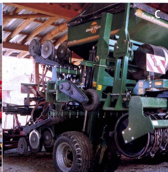
a) Hersage profond: combattre le symptôme au lieu de rechercher l'origine. b) Herse à disques réglables: effet mélange provoqué par l'angle de réglage variable des disques et tassement par le rouleau Packer. c) Semis direct ou sous mulching avec une machine munie de socs à disques. d) Semoir monograinne pour semis sous mulching de maïs et de betteraves à sucre.
