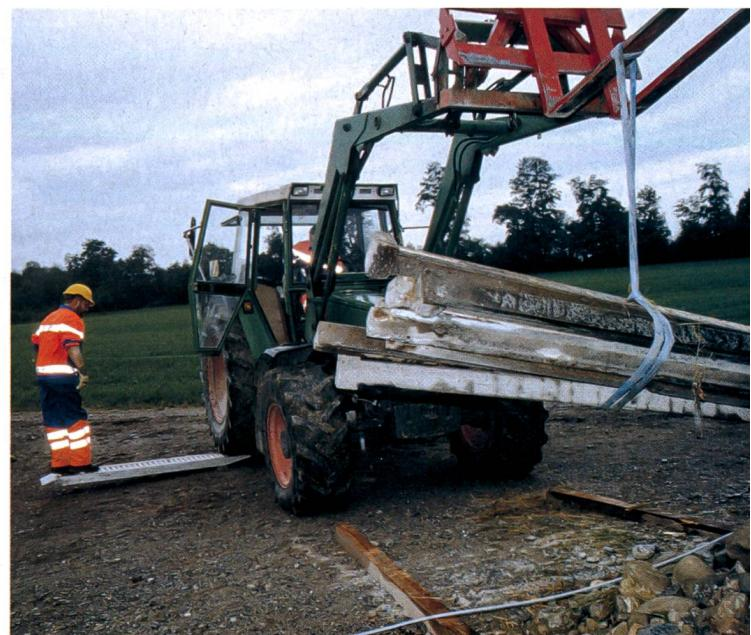
Près de 600 kg sont suspendus à l'élévateur: les accidents de terrain et autres obstacles limitent la stabilité du véhicule par un délestage de l'essieu arrière sans compensation de poids et sont un danger potentiel.
