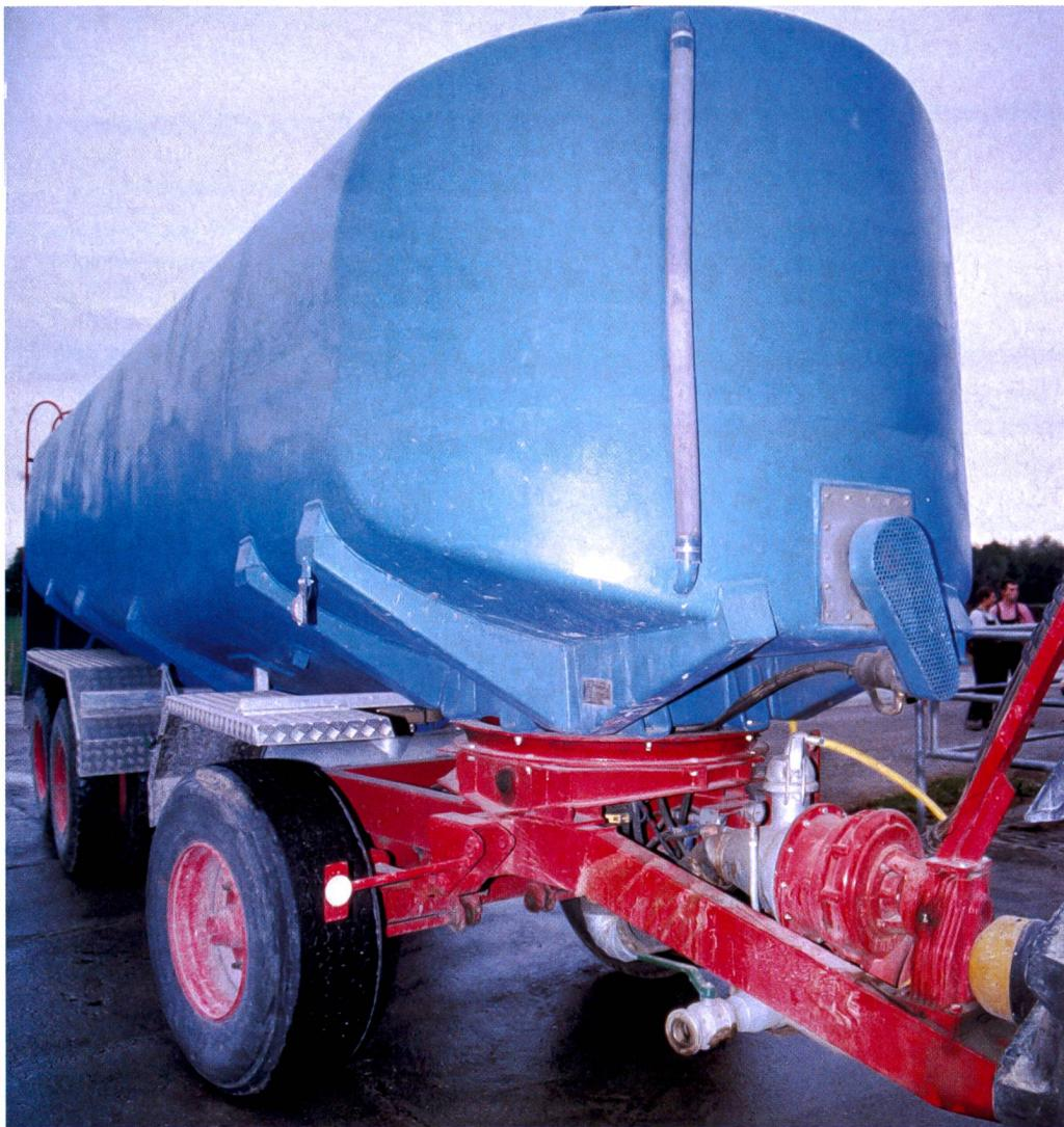
*Le poids de la citerne appuie devant l'essieu avant, sur le châssis et le timon. Ainsi en cas de freinage, la charge du timon augmente et l'adhésion des roues du tracteur s'en trouve renforcée; un point d'attelage bas est de rigueur. Le passage du lisier par le milieu du «tourniquet» permet un angle de braquage extrêmement serré.*
