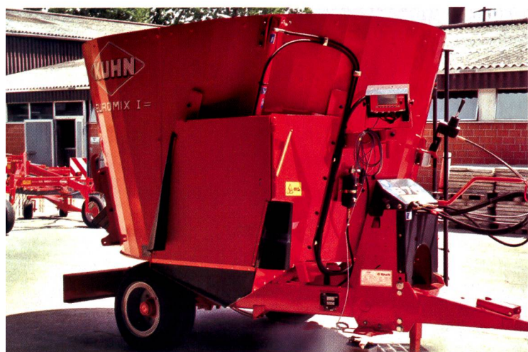
La remorque mélangeuse Kuhn Euromix I Serie 70: la nouvelle série avec vis mélangeuse verticale est conçue selon un système à trémie d'une contenance de 8 à 22 m³. En cas d'augmentation de la taille de l'exploitation, la remorque peut être agrandie après coup. Il existe toute une variété d'équipements accessoires.
