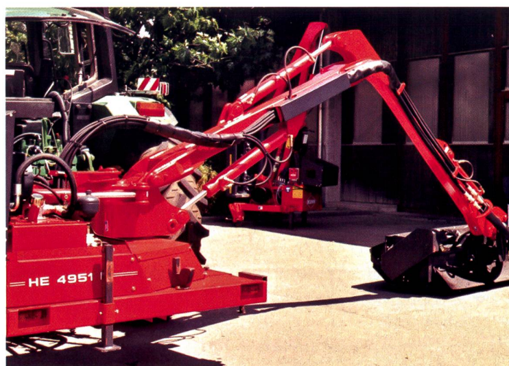
La faucheuse à broussailles Kuhn HE 4951 P: cette faucheuse à broussailles conçue pour une utilisation durable est équipée d'un refroidissement électrique et de commandes électro-hydrauliques confortables. La tête de coupe offre une puissance de 51 CV à la prise de force et peut être équipée d'un rotor de mulching, d'un hacheur à bois ou d'une fraise.
