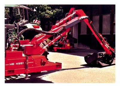
La faucheuse à broussailles Kuhn HE 4951 P: cette faucheuse à broussailles conçue pour une utilisation durable est équipée d'un refroidissement électrique et de commandes électro-hydrauliques confortables. La tête de coupe offre une puissance de 51 CV à la prise de force et peut être équipée d'un rotor de mulching, d'un hacheur à bois ou d'une fraise.
