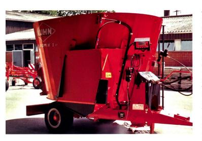
La remorque mélangeuse Kuhn Euromix I Serie 70: la nouvelle série avec vis mélangeuse verticale est conçue selon un système à trémie d'une contenance de 8 à 22 m³. En cas d'augmentation de la taille de l'exploitation, la remorque peut être agrandie après coup. Il existe toute une variété d'équipements accessoires.
