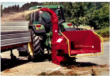
La déchiqueteuse pour jardins, parcs et forêts TP Linddana: le constructeur danois propose des machines pour diverses utilisations. Elle permet de transformer des résidus de jardins et d'arbres, ainsi que des branches jusqu'à un diamètre de 28 cm. Ces machines sont conçues pour être attelées à un tracteur ou posées sur une remorque.
