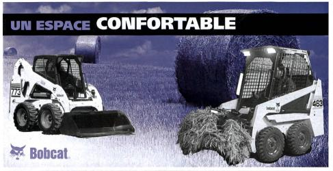
Petites et souples, les chargeuses Bobcat sont de véritables bêtes de travail. La 463, par exemple, est le partenaire idéal de l'agriculteur. Elle passe à travers une ouverture de porte de 95 x 180 cm et convient parfaitement pour le nettoyage et l'évacuation du fumier des écuries, l'affouragement et le transport du foin.
