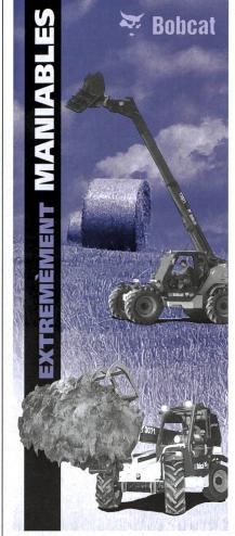
Les chargeuses télescopiques compactes Bobcat peuvent atteindre de grandes hauteurs sur un espace restreint. Le partenaire idéal de l'agriculteur, par exemple lors de l'affouragement, la manipulation des balles de silo, l'évacuation du fumier etc. Les puissances de levage des modèles T 2556/T 3071 vont de 2,5 à 3,0 t et les hauteurs de levage maximales de 5,56 à 7,05 m.
