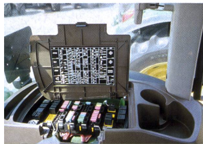
Sur le garde-boue, bien protégées et accessibles, la boîte de guidage et la prise pour diagnostic avec raccord pour l'ordinateur de bord.
