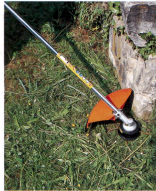
Tête faucheuse pour le fauchage le long des murs, les clôtures et autres obstacles.
