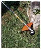
Tête faucheuse pour le fauchage le long des murs, les clôtures et autres obstacles.
