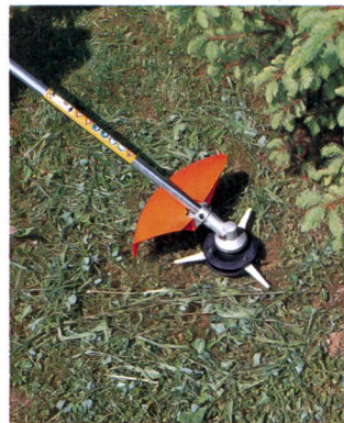
Variante de la tête équipée de trois couteaux mobiles en matière plastique pour le fauchage le long des obstacles ou sur les surfaces herbeuses de taille moyenne.
