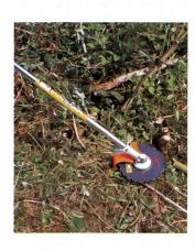
Scie circulaire broussailles boisées et arbustes ainsi que pour travaux de tronçonnage et de défrichage.
