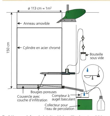
Fig. 4: Un couvercle ferme les lysimètres à la base. L'écoulement conduit à un collecteur où l'eau d'infiltration passe par un compteur à augets basculants, avant d'être recueillie dans des bacs en PVC. Des bougies poreuses en céramique permettent d'aspirer l'eau du sol à 125 cm de profondeur.
