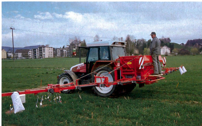
Fig. 3: Le distributeur d'engrais pneumatique répartissait les engrais minéraux dans les parcelles d'essai et l'épandeur à tuyaux souples, le lisier.
