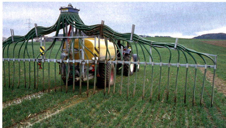
Fig. 3: Le distributeur d'engrais pneumatique répartissait les engrais minéraux dans les parcelles d'essai et l'épandeur à tuyaux souples, le lisier.
