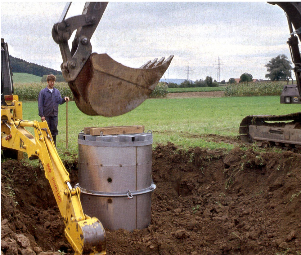
Fig. 1: Un excavateur a placé des cylindres en acier chromé d'un diamètre de 113 cm (surface de 1 m 2 ) à 1,5 m de profondeur dans le sol. Ces dispositifs de mesure, appelés lysimètres, servaient à recueillir l'eau de percolation et à l'envoyer dans un collecteur de manière à déterminer la lixiviation des nitrates.
