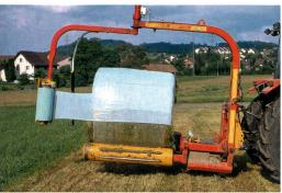
Avant la première utilisation au printemps, contrôler la pré-tension, le recouvrement des feuilles et le nombre de couches souhaitées.
