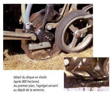
Ouverture horizontale pour le dépôt de la semence et de l'engrais (Cross-slot) dans deux tiers de la profondeur du sillon.
