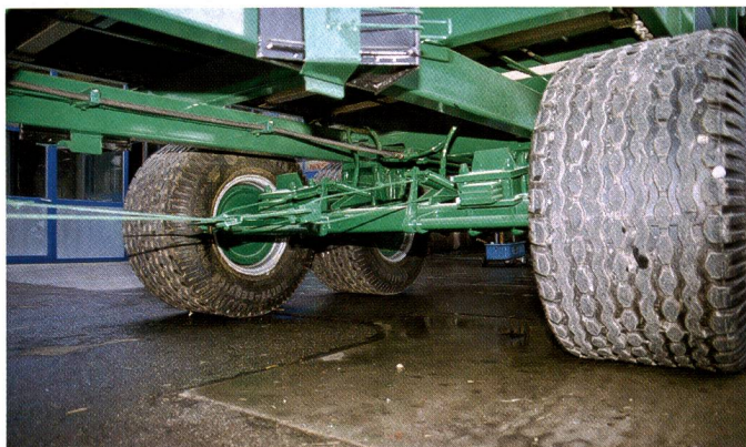
Boggie avec suspension à ressort: Les mouvements verticaux complémentaires de l'essieu avant et arrière du tandem compensent les inégalités de terrain.
