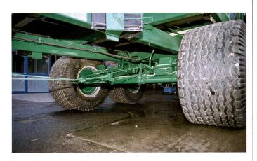
Boggie avec suspension à ressort: Les mouvements verticaux complémentaires de l'essieu avant et arrière du tandem compensent les inégalités de terrain.
