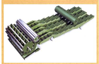
Afin d'augmenter les performances de séparation du grain et de la paille, la John Deere WTS a été équipée d'un tambour de 410 mm doté de dents guidées (Power Separator), placé à l'arrière des secoueurs, ce qui permet d'aérer la paille compacte.
