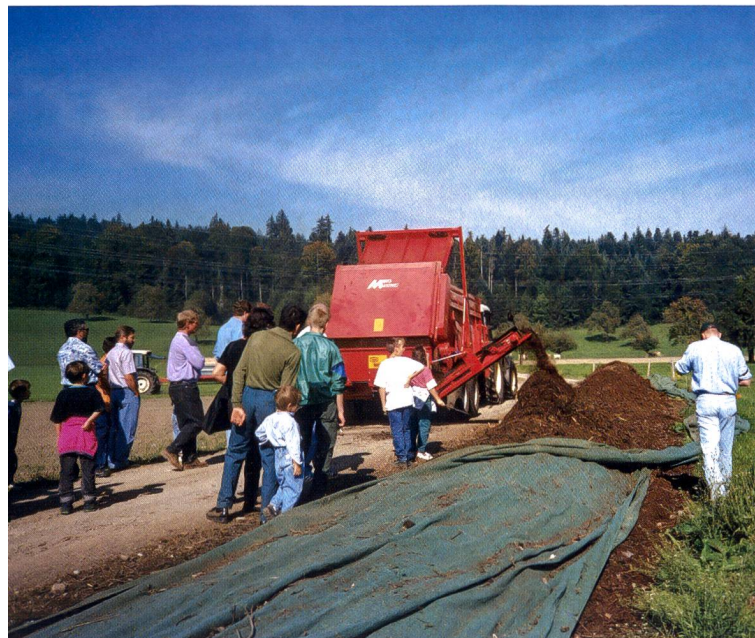
Journée «Portes ouvertes» ou le défi de comprendre l'ensemble du processus: Epandeur à compost avec tapis roulant transversal pour le façonnage des andains.
