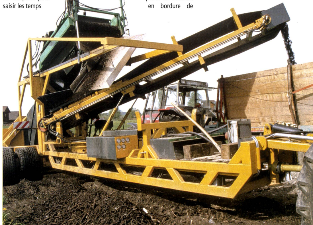
Le «chargeur-tamiseur» de compost. La finesse du compost peut être réglée par le compte-tour de l'agrégat de tamisage. Pour fonctionner sans bavure, le compost doit être bien sec, la règle de tout processus de tamisage. Etant donné la portance du sol en général réduite près de l'andain, les exigences requises des pneumatiques sont très élevées. Franzsepp Erni pense qu'il faudra tôt ou tard couler une dalle en béton sous l'andain.
