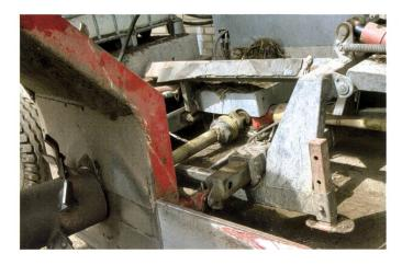
La modification de l'angle de réglage du «retourneur» de compost permet aussi de déposer le compost avec précision, même dans les pentes.
