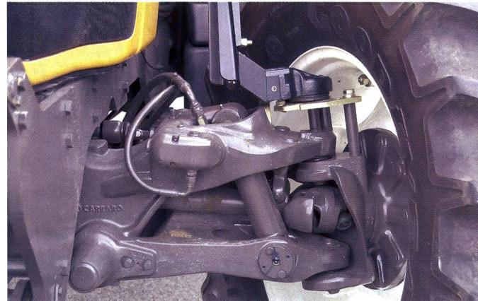
*La suspension avant empêche le tracteur de tanguer. Les rotations planes au niveau du siège du conducteur sont considérablement réduites et la conduite plus confortable. La sécurité de conduite dans la plage de vitesse supérieure à 30 km/h s'en trouve considérablement accrue.*
