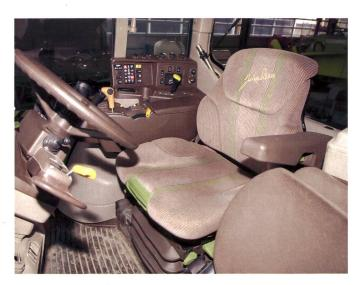
Un siège conducteur confortable avec une bonne suspension générale et une suspension horizontale réglable en longueur et sur les côtés protège également le dos des oscillations et des à-coups douloureux dans le sens longitudinal et transversal.
