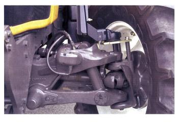
La suspension avant empêche le tracteur de tanguer. Les rotations planes au niveau du siège du conducteur sont considérablement réduites et la conduite plus confortable. La sécurité de conduite dans la plage de vitesse supérieure à 30 km/h s'en trouve considérablement accrue.
