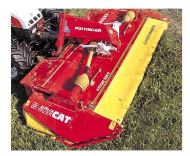
Les avantages principaux des faucheuses à disques sont une construction compacte et une répartition large du fourrage fauché.
