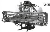
Buses injection Turbo-Drop Réservoir à eau de rinçage/lavage Rampe hydr. 8–24 m
