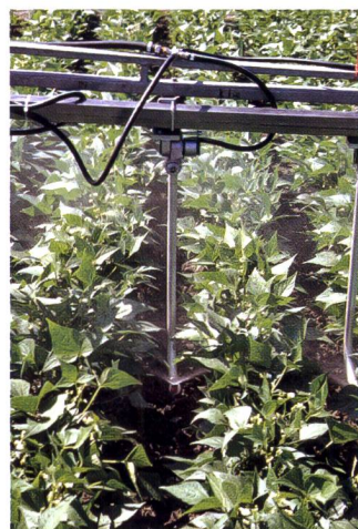
Fig. 3: Avec le dispositif de pulvérisation sous-foliaire, les fanes des pommes de terre et des haricots nains sont traitées de biais par le haut et par dessous (gauche: Fischer, CH, et Benest, GB).
