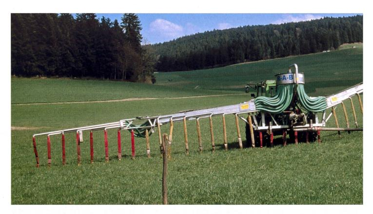
Attention: l'aile intérieure est relevée de manière à ce que davantage de lisier coule à l'extérieur, ce qui assure une répartition régulière. Les angles peuvent être réglés par un système hydraulique aux articulations à charnières, entre les ailes et la partie centrale, ainsi qu'au milieu de chaque aile. Ainsi, dans les pentes, l'on peut puriner de moins grandes surfaces en amont qu'en aval, ce qui permet une répartition régulière.
