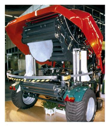
Triomphe de l'ensilage à balles rondes: la machine la plus compacte intègre presse et enrubanneuse.
