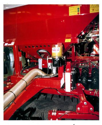
Confort des machines de travail: de plus en plus, elles sont équipées d'un point de graissage central. Ici, un semoir combiné de Horsch.
