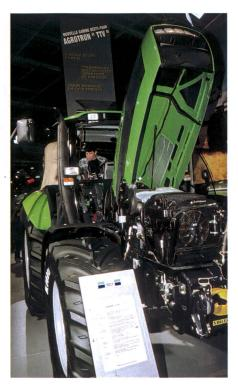
Modèle de pointe chez Same-Deutz-Fahr: l'Agrotron TTV, avec transmission ZF Econom, moteur Deutz avec pompe à haute pression individuelle et intercooler. Et d'une seule main, le conducteur règle 19 fonctions par joystick (PowrComV).
