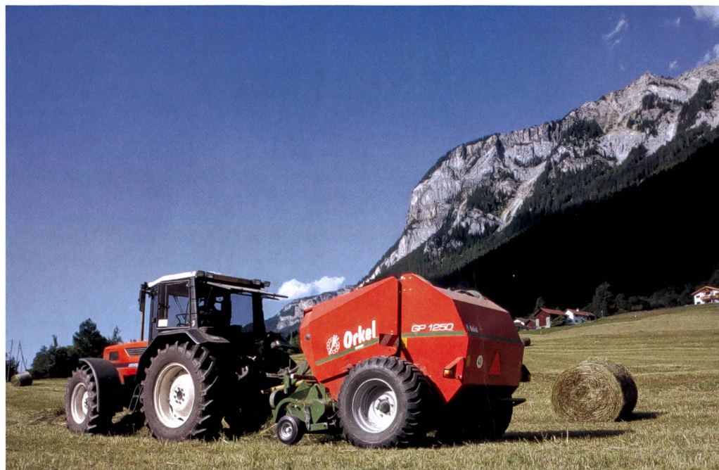
La plupart des presses à balles rondes sont assez bien adaptées aux pentes en raison de leur centre de gravité bas et de leur voie large. Des pneus à barrettes évitent le glissement latéral.
