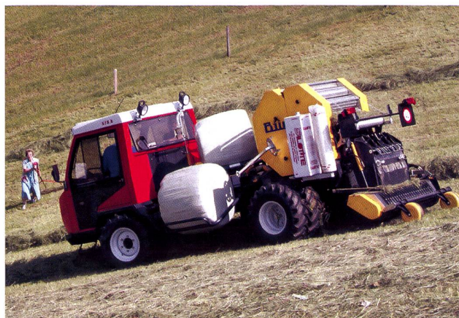
Presse portée pour transporteur «prewitra»: une technique aboutie pour les pentes! (photo: Lorenz Duerr, FAT).
