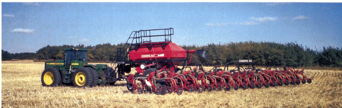
Fig. 4: Machine de semis direct de 18 m de large (Conserva Pak) permettant le semis et la fumure simultanés.
