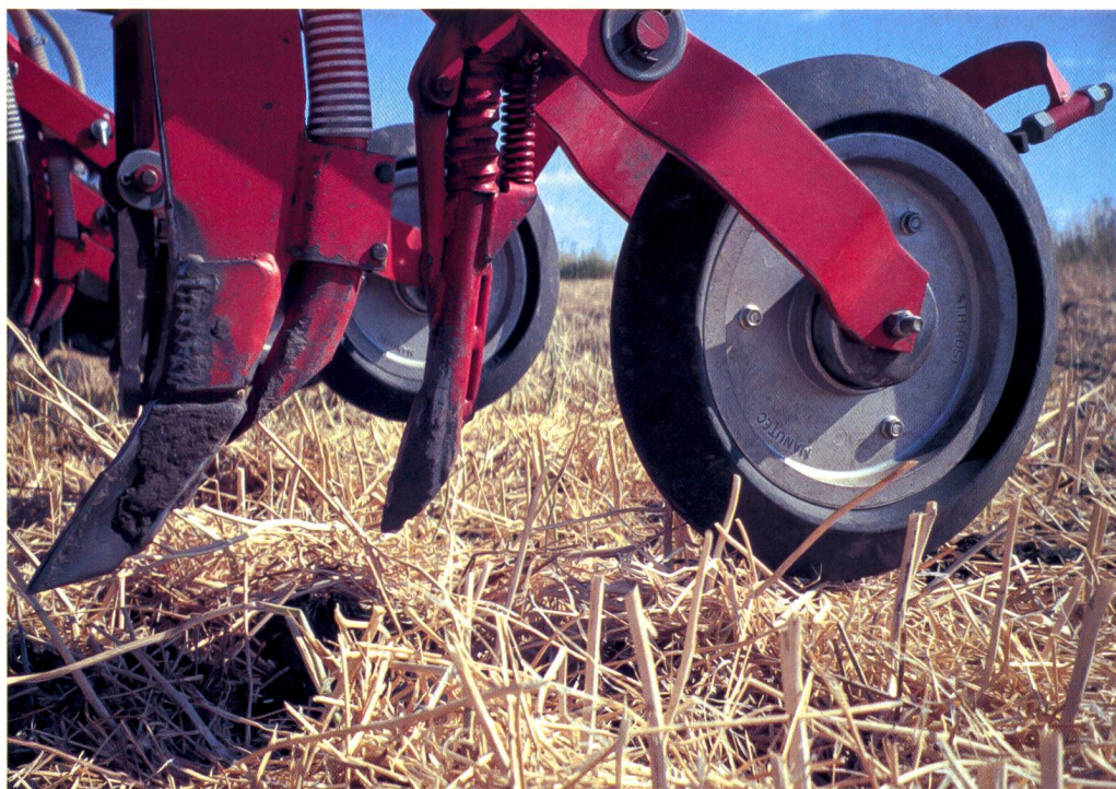
Fig. 5: Unité du semoir avec soc de fumure à l'avant et soc semeur à l'arrière (Conserva Pak).
