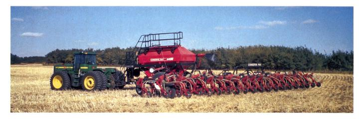
Fig. 4: Machine de semis direct de 18 m de large (Conserva Pak) permettant le semis et la fumure simultanés.
