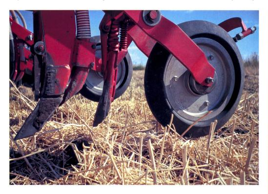
Fig. 5: Unité du semoir avec soc de fumure à l'avant et soc semeur à l'arrière (Conserva Pak).
