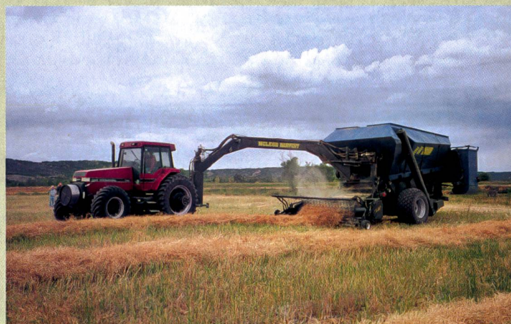
Fig. 2: Unité de battage tractée du système de récolte «McLeod».
