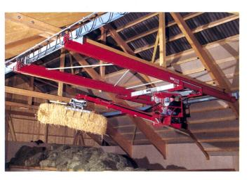
La fourche à foin classique permet le transport de grosses balles. La force de traction maximale doit être particulièrement observée avec le silo.
