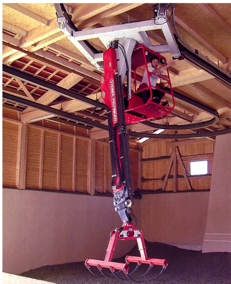
Des voies en courbe facilitent l'utilisation de volumes complémentaires. Les lignes électriques, d'où provient le courant sans qu'un câble ne soit nécessaire, sont visibles en haut à droite.
