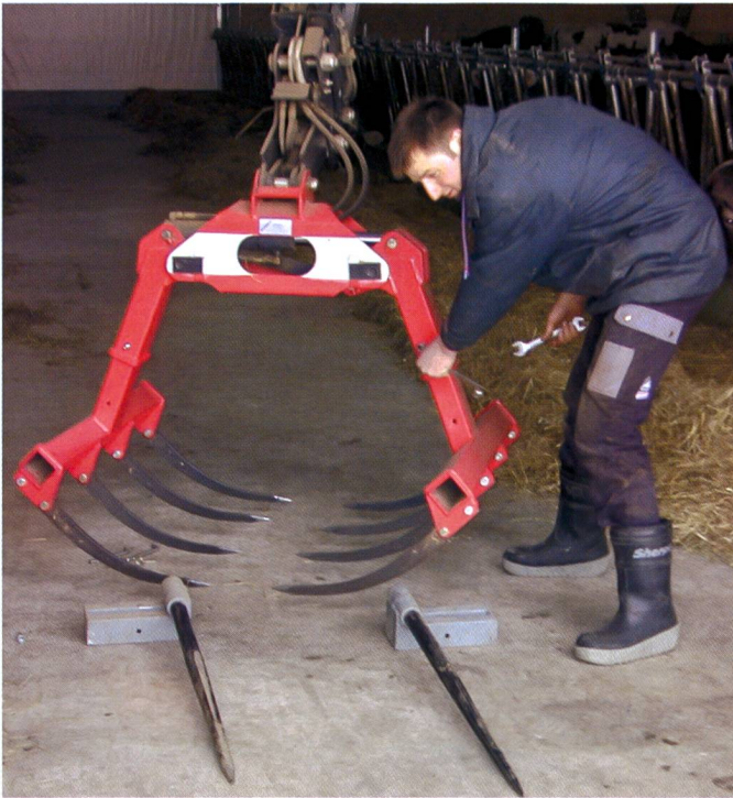
Une manipulation simple permet d'enlever les fourches et la pose de deux pointes...
