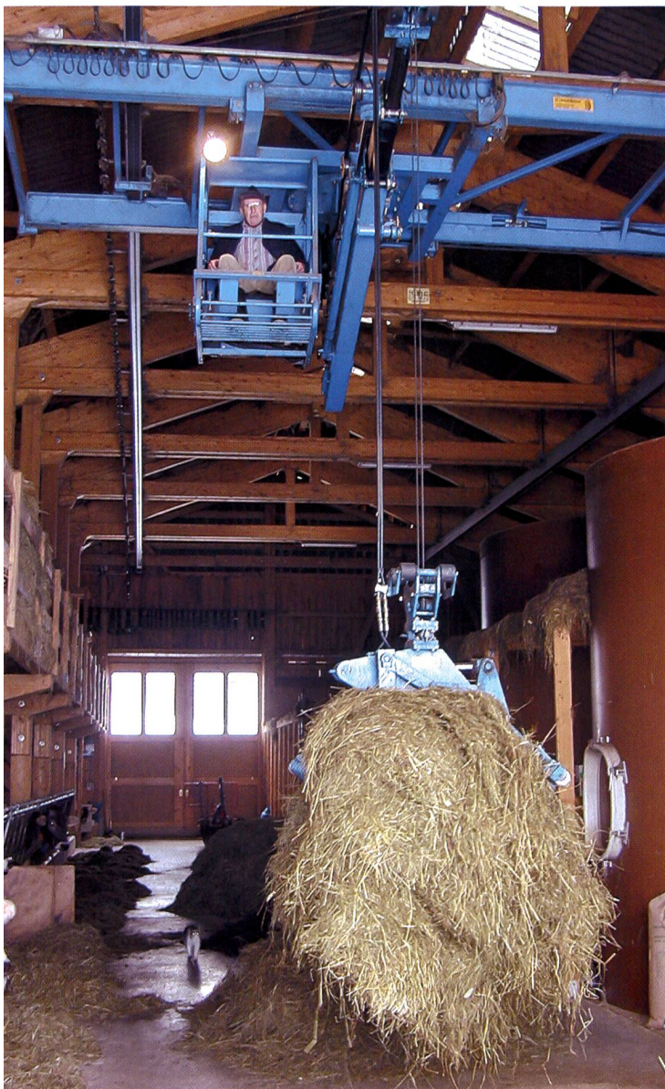
Les granges-halles favorisent une utilisation plus polyvalente. Le treuil à câble permet la reprise du fourrage dans les silos-tours. Un déplacement latéral améliore la vision.
