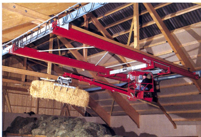
La fourche à foin classique permet le transport de grosses balles. La force de traction maximale doit être particulièrement observée avec le silo.
