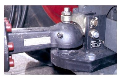
Fabriqué par Scharmüller (Autriche) l'attelage à rotule peut supporter sans jeu une charge au timon jusqu'à 3000 kg.
