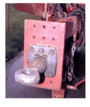
L'œillet d'attelage renforcé, DIN 11026 pour remorques d'un poids total max. de 20 t, a une épaisseur de 43 mm, une ouverture cylindrique de 40 mm et un diamètre extérieur de 100 mm. Exécution avec une plaque de fixation normalisée.
