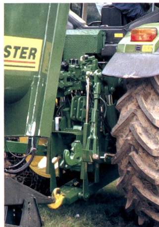
...piton mobile: ne peuvent être couplés qu'avec l'œillet adéquat selon ISO 20019.
