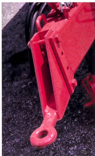
L'œillet d'attelage standard, DIN 74054 pour remorques d'un poids total max. de 12 t, à une épaisseur de 30 mm, un perçage cylindrique de 40 mm et un diamètre extérieur de 100 mm.
