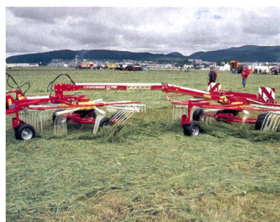
Avec un double-rotors et andainage latéral, différents types d'andains peuvent être constitués selon la quantité de fourrage. Par rapport à l'andainage central, l'utilisation est plus difficile.
