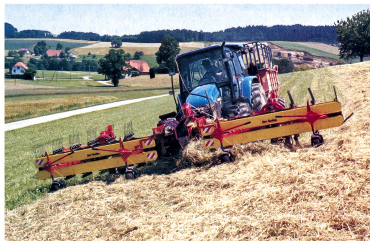
Le faneur-andaineur à bande, de la firme Knüsel, permet un andainage performant qui ménage le fourrage; il est particulièrement adapté aux terrains en pente. Grâce au dépôt central, l'andainage et le ramassage peuvent se réaliser en un seul passage (photo: Knüsel, Küssnacht).
