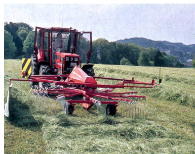
Andaineur à rotors frontal: Bonne visibilité sur la machine sans passage sur le fourrage. L'adaptation au sol est cependant insuffisante lorsque celui-ci est irrégulier.
