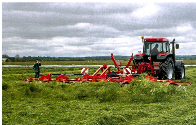
En production fourragère, des surfaces de plus en plus grandes doivent être travaillées par une seule unité de travail. L'intérêt pour les faneuses performantes à 6, 8 ou même 10 toupies augmente d'autant.
