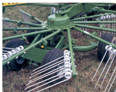
Les grands andaineurs mono-rotor disposent d'un dispositif fermé, d'une attache souple du rotor, d'un essieu tandem à roues décalées et de douze bras, portant chacun quatre paires de dents.
