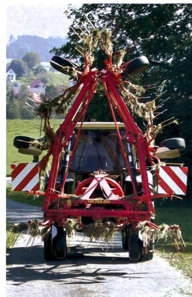
Les faneuses de grandes dimensions pour attelage 3-points impliquent des systèmes de repli hydrauliques complexes pour les transports sur route. Pour les machines tractées, les parties latérales de certains modèles ne se replient pas en hauteur, mais sont placées vers l'arrière. Cette solution est plus économique, mais entraîne des longueurs de transport considérables (photo: FAT).
