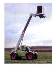
Les chargeurs télescopiques de Claas (Targo K et Targo C) offrent une force de levage élevée jusqu'à une hauteur de 7,2 m, un rayon de braguage réduit et un confort d'utilisation élevé.
