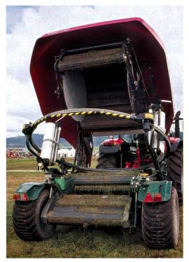
Une réelle nouveauté dans les presses à balles rondes: le nouveau modèle «bio» de Taarup, une presse à chambre fixe dotée de 18 rouleaux, enrubanneuse incluse. Cette presse permet de presser et d'enrubanner en un passage («Bale in one»). Conséquences pour la récolte de balles d'ensilage: une réduction sensible des coûts et de la main-d'œuvre. La presse est en outre équipée d'un organe de coupe de 2,1 m. (lonqueur de coupe: 70 mm), d'un large pick up et d'un dérouleur de filet.
