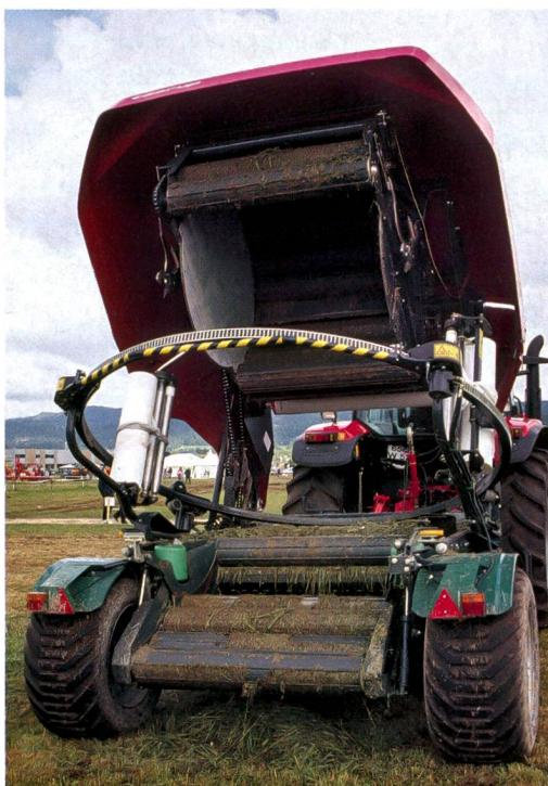
*Une réelle nouveauté dans les presses à balles rondes: le nouveau modèle «bio» de Taarup, une presse à chambre fixe dotée de 18 rouleaux, enrubanneuse incluse. Cette presse permet de presser et d'enrubanner en un passage («Bale in one»). Conséquences pour la récolte de balles d'ensilage: une réduction sensible des coûts et de la main-d'œuvre. La presse est en outre équipée d'un organe de coupe de 2,1 m. (longueur de coupe: 70 mm), d'un large pick up et d'un dérouleur de filet.*
