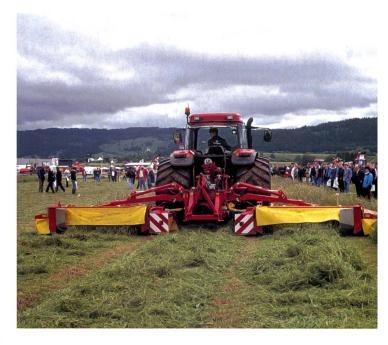
«Plus grand, plus vite, plus large» ce leitmotiv est aussi présent à Pontarlier. La combinaison triple avec une faucheuse à l'avant et deux à l'arrière de Pöttinger, d'une largeur totale de 7,5 m permet de faucher jusqu'à 8 ha à l'heure. Cette technique onéreuse est encore trop peu répandue auprès des agro-entrepreneurs.
