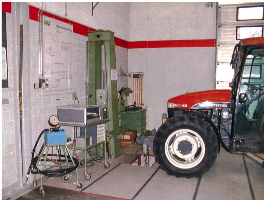
Fig. 5: Capacité de levage de l'hydraulique: le banc d'essai permet de mesurer la capacité de levage sur toute la plage de levage de bas en haut. Le rapport de test indique la valeur obtenue sur toute la plage de levage.
