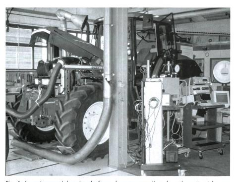
Fig. 1: La puissance à la prise de force, la consommation de carburants et les gaz d'échappement émis par le moteur sont des paramètres de comparaison importants pour un tracteur. Un banc d'essai équipé des appareils de mesure les plus modernes et d'un système électronique de traitement des données permet de travailler rapidement et d'interpréter immédiatement les résultats.
