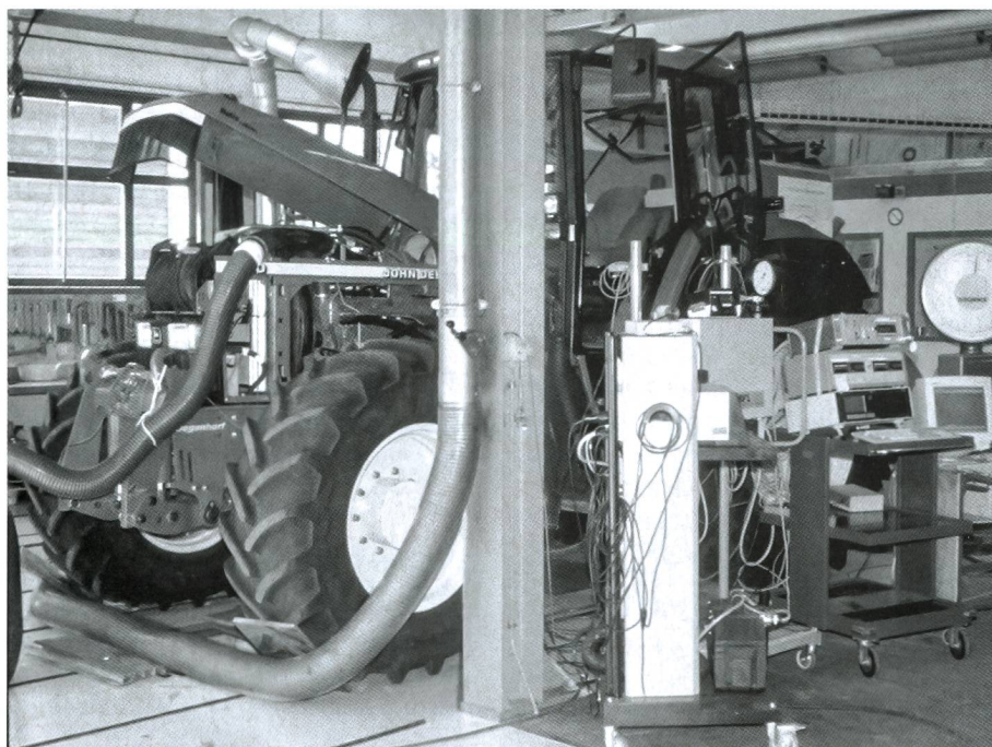
Fig. 1: La puissance à la prise de force, la consommation de carburants et les gaz d'échappement émis par le moteur sont des paramètres de comparaison importants pour un tracteur. Un banc d'essai équipé des appareils de mesure les plus modernes et d'un système électronique de traitement des données permet de travailler rapidement et d'interpréter immédiatement les résultats.
