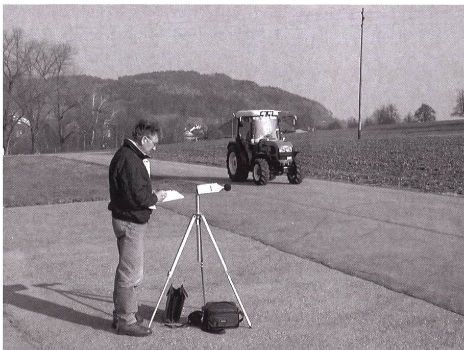
Fig. 3: Les tracteurs agricoles sont souvent sur le terrain dès l'aube et travaillent jusqu'tard le soir. C'est pourquoi ils ne devraient pas faire trop de bruit. La mesure du bruit au passage du tracteur a lieu des côtes de l'engin à une distance de 7,5 mètres. Le rapport de test indique la plus haute des deux valeurs.
