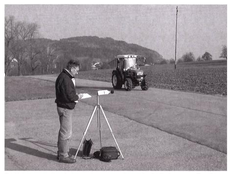
Fig. 3: Les tracteurs agricoles sont souvent sur le terrain dès l'aube et travaillent jusque tard le soir. C'est pourquoi ils ne devraient pas faire trop de bruit. La mesure du bruit au passage du tracteur a lieu des côtes de l'engin à une distance de 7,5 mètres. Le rapport de test indique la plus haute des deux valeurs.
