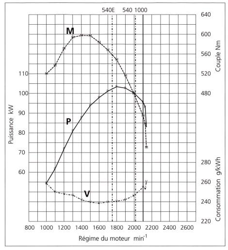
Fig. 2: Le diagramme de puissance indique les courbes à peine charge du couplemoteur M, de la puissance P et de la consommation spécifique V d'un tracteur, mesurée à la prise de force.
