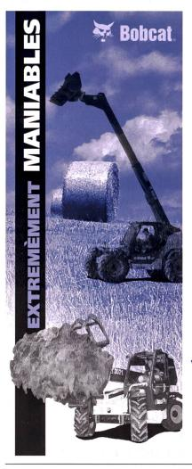
Les chargeuses télescopiques compactes Bobcat peuvent atteindre de grandes hauteurs sur un espace restreint. Le partenaire idéal de l'agriculteur, par exemple lors de l'affouragement, la manipulation des balles de silo, l'évacuation du fumier etc. Les puissances de levage des modèles T 2556/T 3071 vont de 2,5 à 3,0 t et les hauteurs de levage maximales de 5,56 à 7,05 m.
