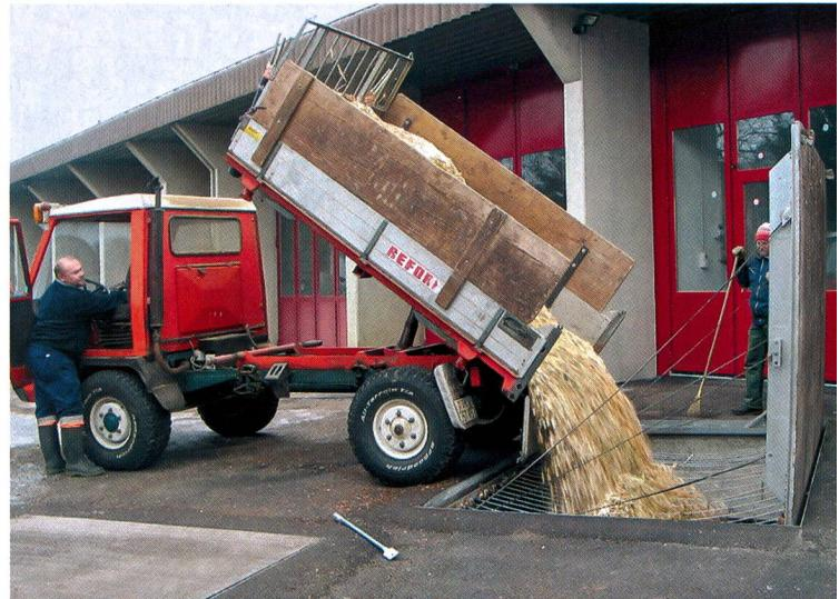
*L'installation de chauffage à plaquettes fonctionne automatiquement en charge partielle de 30 à 100%, excepté quelques manipulations mineures. Ainsi, la pose d'un accumulateur s'avère inutile. Les coûts d'investissement s'élèvent à environ un tiers de plus que ceux d'un chauffage à bûches. Une chaîne de mécanisation complète depuis le déchiquetage en forêt jusqu'à la combustion dans la chaudière est nécessaire.*
