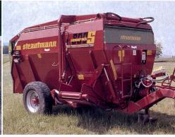
La mélangeuse horizontale «Multimix» de Strautmann se décline en 2 et 4 vis avec poussoir de dosage hydraulique de chaque côté. «Vertimix», mélangeuse verticale, est disponible avec 1 ou 2 vis. Depuis peu, des mélangeuses automotrices verticales et horizontales Strautmann se trouvent sur le marché.
