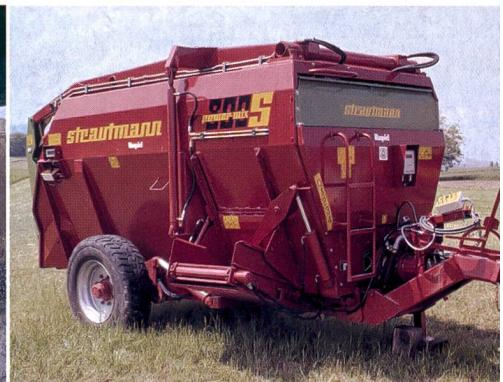
La mélangeuse horizontale «Multimix» de Strautmann se décline en 2 et 4 vis avec poussoir de dosage hydraulique de chaque côté. «Vertimix», mélangeuse verticale, est disponible avec 1 ou 2 vis. Depuis peu, des mélangeuses automotrices verticales et horizontales Strautmann se trouvent sur le marché.
