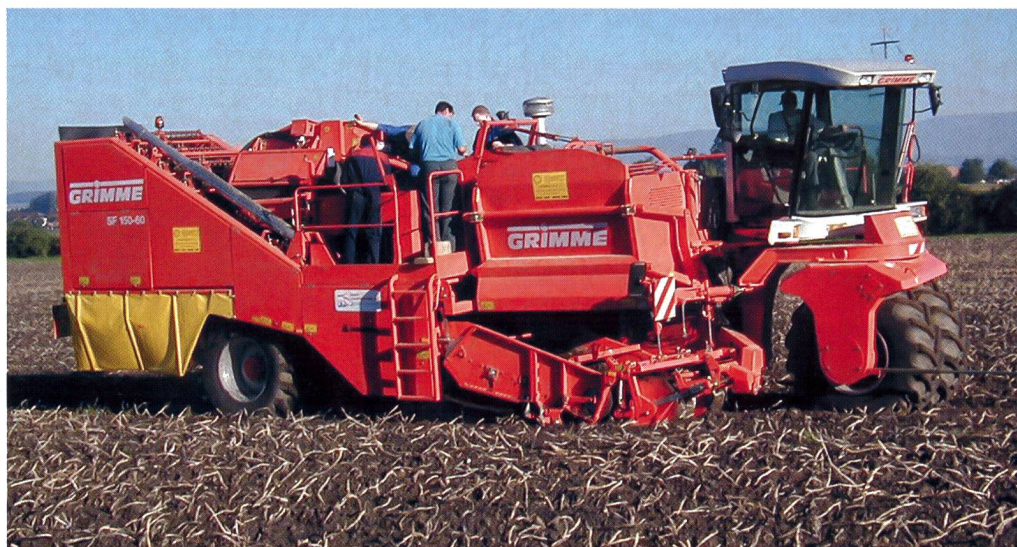
Evolution la plus récente: récolteuse intégrale à chenilles à quatre rangs (Grimme). Ce niveau de mécanisation exige des conditions de sol parfaites et une organisation de récolte de premier plan.
