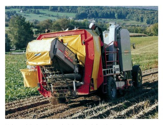
Récolteuse totale des plus modernes avec bande de séparation des fanes à larges mailles et trois convoyeurs à ergots avec nettoyeurs rotatifs (Samro).
