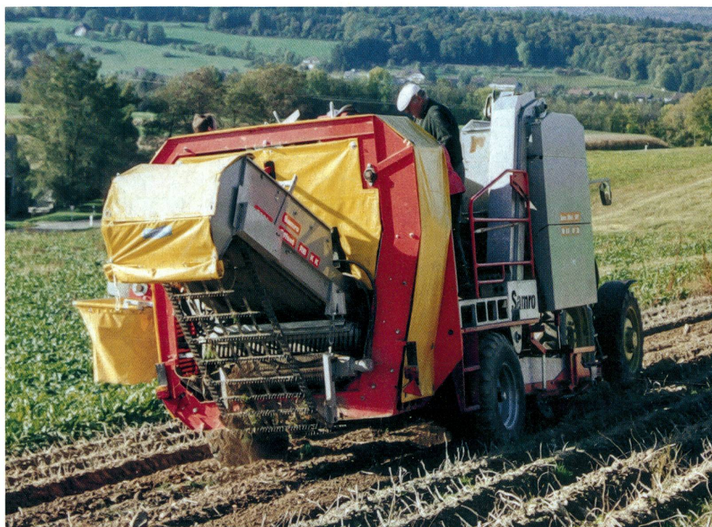
Récolteuse totale des plus modernes avec bande de séparation des fanes à larges mailles et trois convoyeurs à ergots avec nettoyeurs rotatifs (Samro).
