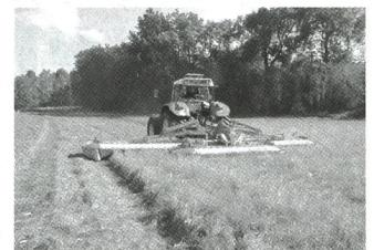
du fourrage par rapport à la technique conventionnelle. Le conditionneur «Extra dry» contribue à augmenter la teneur énergétique du fourrage d'environ 10%, ce qui est primordial pour des animaux à haute productivité. Si le conditionneur n'est pas nécessaire, il est démontable en quelques minutes par une seule personne.
