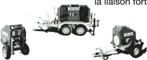
Dynamomètres pour des puissances de 5 kW jusqu'à 450 kW, précis, refroidis par air, lecture directe, facile à calibrer, la technologie pour le futur. Logiciel: méthode et indications répondant aux normes DIN 70020 - iso 3046.
