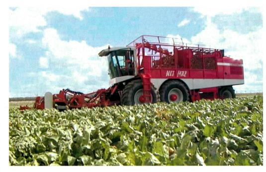
Vervaet (NL) propose cette année pour la première fois une décolleteuse-arracheuse à trémie à neuf rangs. La voie de l'essieu avant peu s'élargir de 1 m pendant la phase de travail par déplacement des roues (diamètre 2,1 m), entraînant une surface des ornières couvrant presque l'intégrité de la parcelle. L'effeuilleuse et l'arracheuse se replient en deux et trois parties pour le transport routier. Le nettoyage se fait au moyen de 8 turbines et la contenance de la trémie s'élève à 27 t.
