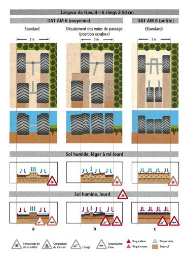
Fig 1: Différentes conceptions de trains roulants avec leurs effets sur les contraintes au sol pour une décolleteuse-arracheuse à trémie à six rangs. a) en ligne b) décalé c) sans passage superposé des roues.
