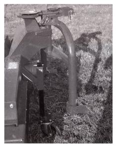
Fig. 4: Les quatre conditionneurs sont équipés d'une tête d'attelage pivotante. Elle permet à l'outil traîné de suivre sans problème lorsque le tracteur doit prendre des virages.
