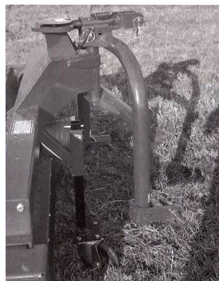
Fig. 4: Les quatre conditionneurs sont équipés d'une tête d'attelage pivotante. Elle permet à l'outil trainé de suivre sans problème lorsque le tracteur doit prendre des virages.
