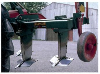
Fig. 2, Chisel: Le chisel ameublit le sol à 15-25 cm de profondeur. Le semis se fait avec une combinaison d'outils (fig. 3). L'ameublissement complémentaire produit par le chisel a rarement apporté une amélioration du rendement.
