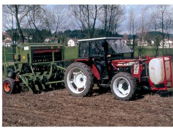
Fig. 4, Semis direct: Ni travail du sol en profondeur, ni préparation du lit de semences ne sont pratiqués ici. Ce procédé pose les exigences les plus élevées quant à la parcelle et à la protection des plantes.
