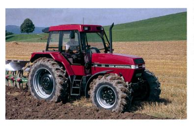
Fig. 3, Travail superficiel du sol: Aucun travail du sol en profondeur n'a été réalisé. Ce procédé fonctionne de manière fiable et constitue un bon compromis en le travail du sol en profondeur et le semis direct.
