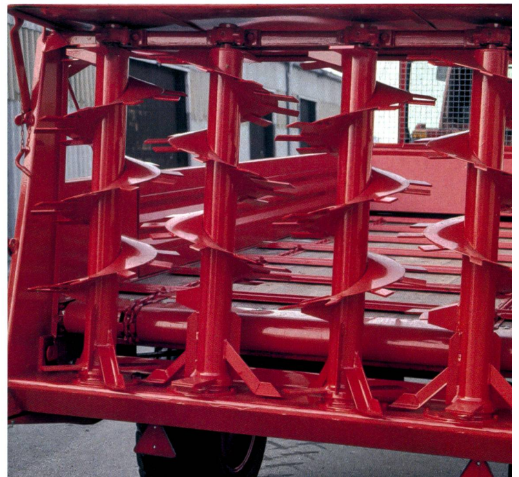
Les systèmes d'épandage avec quatre hérissons verticaux sont les mieux adaptés pour les exploitations herbagères en raison de la bonne qualité de travail (largeur d'épandage, finesse de répartition, quantité épandue).
