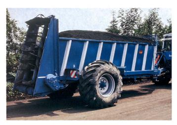
Epandeurs-bennes à essieu surbaissé et pneus de tracteur. Le système d'épandage robuste à deux hérissons verticaux se révèle comme le plus approprié pour le fumier compact de stabulation libre.
