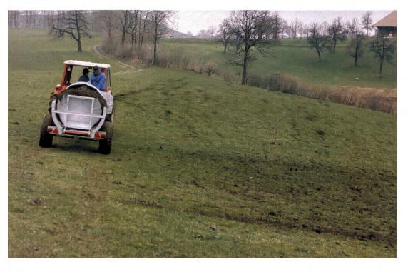
Les épandeurs latéraux à essieu surbaissé et paroi coulissante ne sont pas seulement à l'aise en terrains en pente, mais convainquent aussi grâce à la répartition longitudinale exacte et la finesse d'épandage.
