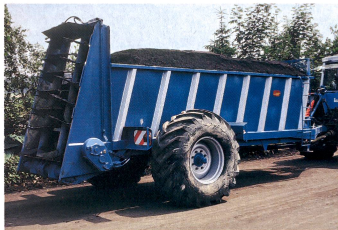
Epandeurs-bennes à essieu surbaissé et pneus de tracteur. Le système d'épandage robuste à deux hérissons verticaux se révèle comme le plus approprié pour le fumier compact de stabulation libre.
