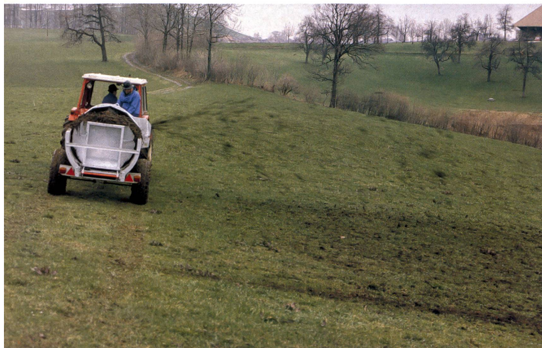
Les épandeurs latéraux à essieu surbaissé et paroi coulissante ne sont pas seulement à l'aise en terrains en pente, mais convainquent aussi grâce à la répartition longitudinale exacte et la finesse d'épandage.
