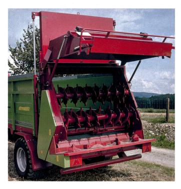
Les épandeurs à compost avec fraise et assiettes de répartition sont utilisables de manière très polyvalente. La paroi anti-bourrage assure un déchargement régulier du matériau. Ces épandeurs doivent disposer d'une capacité de chargement suffisante en raison de la largeur d'épandage élevée.
