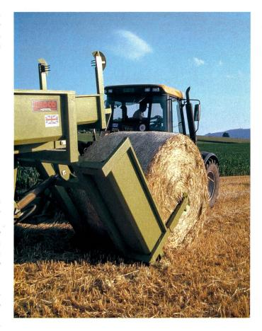
Autochargeuse Rhoco, Yorkshire, GB. La machine ramasse de 10 à 12 balles rondes, selon le diamètre, en abaissant le quart avant d'une de ses voies, sans s'arrêter; deux griffes latérales saisissent les balles au sol qui se placent l'une derrière l'autre. Chargement et déchargement très rapide.
