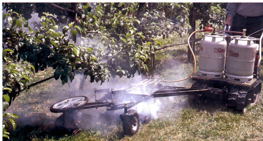
Fig. 6: La régulation exclusivement thermique des adventices va de pair avec une consommation relativement élevée de gaz propane. Gauche/droite: brûleur sur le tracteur ou véhicule à chenilles (souvent risque d'incendie des touffes de graminées).
