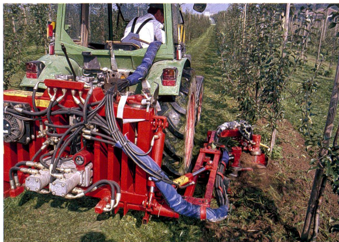
Fig. 1: Quatre à cinq passages de la sarcleuse suffisent en général pour la régulation des adventices et à l'entretien du sol. A gauche: Ladurner, avec circuit hydraulique séparé avec réservoir de refroidissement à ailettes et ventilateur; à droite: résultat du travail dans les rangées d'arbres avec Humus.
