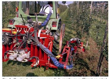
Fig. 1: Quatre à cinq passages de la sarcleuse suffisent en général pour la régulation des adventices et à l'entretien du sol. A gauche: Ladurner, avec circuit hydraulique séparé avec réser-
