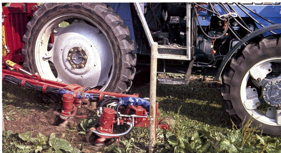
Fig. 1.1: La sarcleuse Ladurner est celle qui a obtenu les meilleurs résultats dans un sol lourd, recouvert d'une végétation dense.
