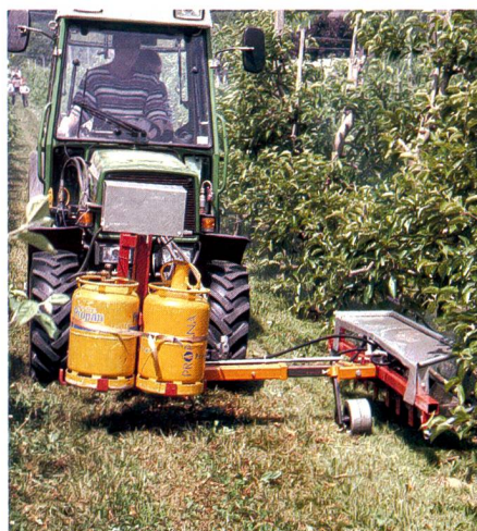
Fig. 6: La régulation exclusivement thermique des adventices va de pair avec une consommation relativement élevée de gaz propane. Gauche/droite: brûleur sur le tracteur ou véhicule à chenilles (souvent risque d'incendie des touffes de graminées).
