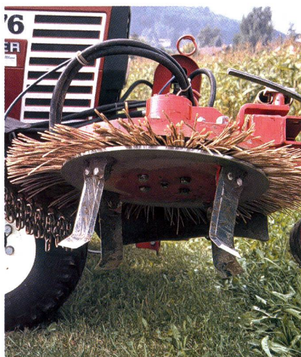
Fig. 2: Pour obtenir de bons résultats, le système de guidage du bras tâteur doit être réglé avec précision (Humus). Au centre: les couteaux de 15 cm recourbés vers l'intérieur sont préférables aux couteaux de 10 cm (à droite).
