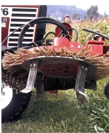
Fig. 2: Pour obtenir de bons résultats, le système de guidage du bras tâteur doit être réglé avec précision (Humus). Au centre: les couteaux de 15 cm recourbés vers l'intérieur sont préférables aux couteaux de 10 cm (à droite).
