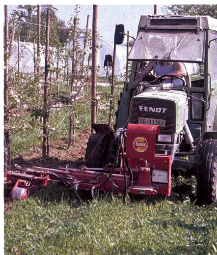
Fig. 2: Pour obtenir de bons résultats, le système de guidage du bras tâteur doit être réglé avec précision (Humus). Au centre: les couteaux de 15 cm recourbés vers l'intérieur sont préférables aux couteaux de 10 cm (à droite).
