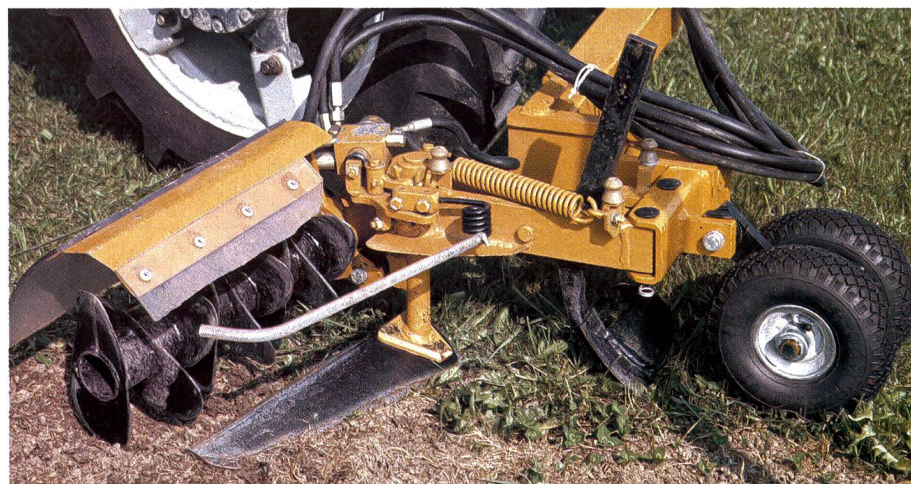
Fig. 3: La couche superficielle est soulevée par le soc plat. La couche herbeuse broyée à l'aide du rotor à couteaux est enfouie dans le sol (Müller).
