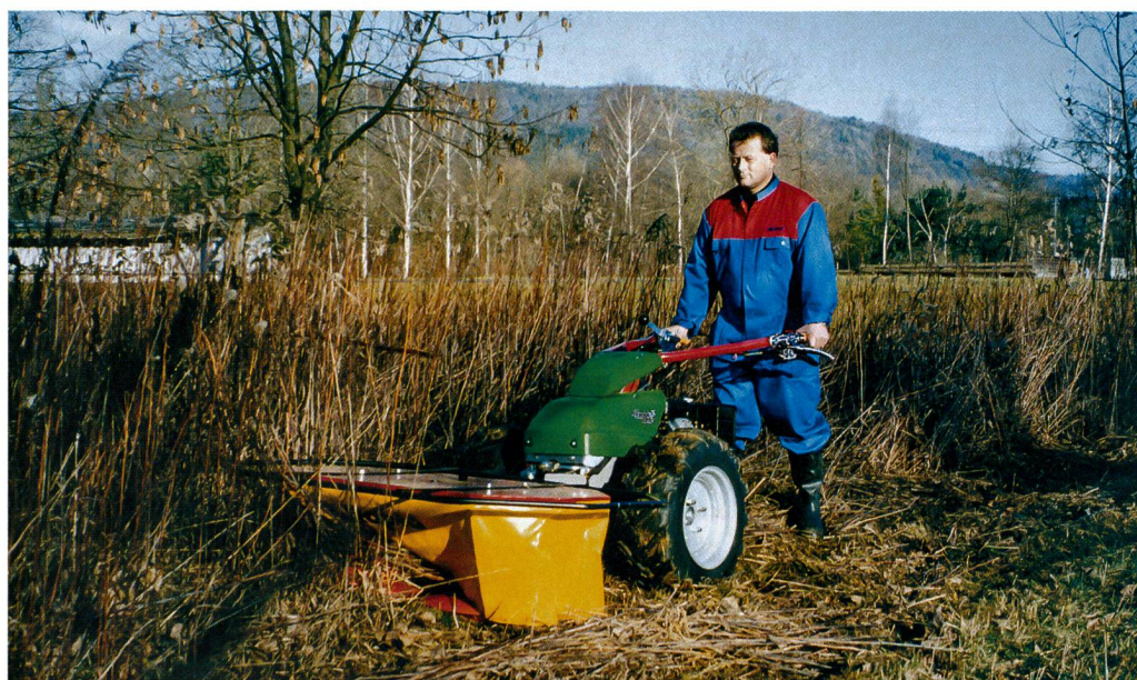
Elargissement du champ d'action des monoaxes par des agrégats spéciaux. Utilisation d'une faucheuse à fléaux pour les soins d'une jachère.
