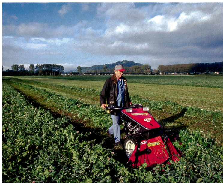
Motofaucheuse classique pour la récolte du fourrage vert avec transmission moderne et andaineur à fourche.
