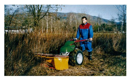
Elargissement du champ d'action des monoaxes par des agrégats spéciaux. Utilisation d'une faucheuse à fléaux pour les soins d'une jachère.
