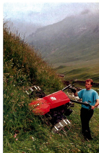
Des développements ergonomiques se sont également produits pour les grosses machines utilisées dans les pentes. Des roues jumelées avec roues cage supplémentaires augmentent la sécurité.
