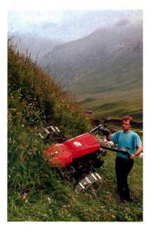
Des développements ergonomiques se sont également produits pour les grosses machines utilisées dans les pentes. Des roues jumelées avec roues cage supplémentaires augmente la sécurité.
