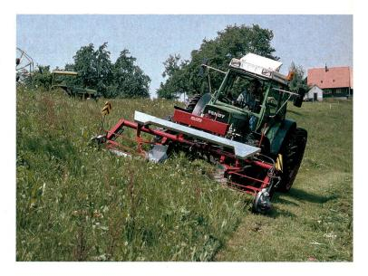
Barre de coupe à double rangée de lames en frontal: poids minimum, besoins de puissance modérés et hautes performances de fauchage. Le dispositif amène l'herbe au milieu et l'éparpille entre les roues du tracteur.
