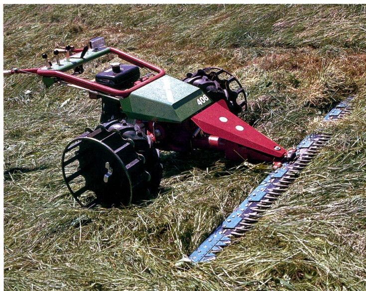
Motofaucheuse avec barre de coupe à doigts: depuis toujours, la solution la plus sûre dans les pentes et la plus protectrice pour le sol!
