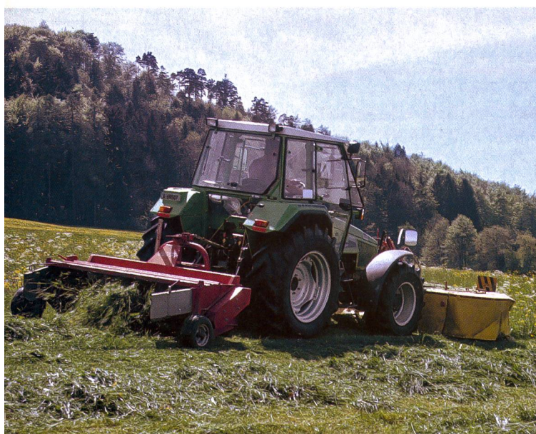
La combinaison faucheuse frontale et conditionneur à l'arrière est une solution souple et fiable sur les pentes. Pour des raisons de coûts, il convient de bien la rentabiliser.
