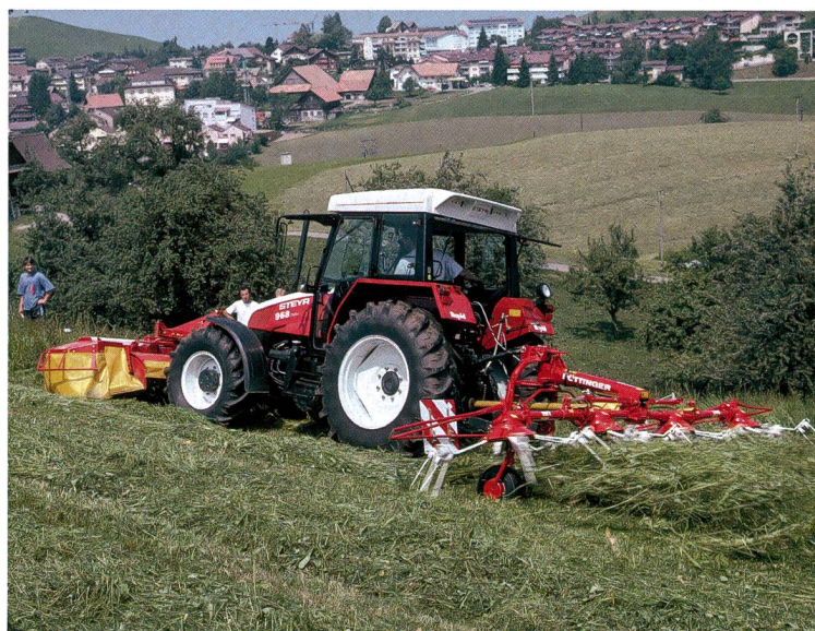
Le conditionnement avec la pirouette derrière la faucheuse frontale permet un travail rationnel mais n'est à recommander que lorsque les végétaux et le sol sont bien secs.
