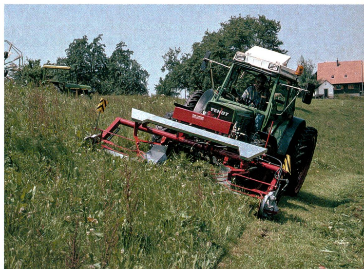
Barre de coupe à double rangée de lames en frontal: poids minimum, besoins de puissance modérés et hautes performances de fauchage. Le dispositif amène l'herbe au milieu et l'épargne entre les roues du tracteur.
