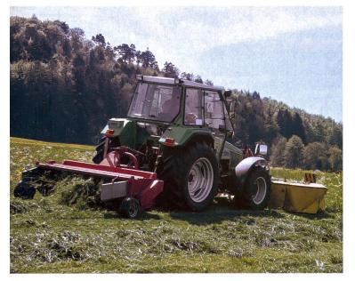
La combinaison faucheuse frontale et conditionneur à l'arrière est une solution souple et fiable sur les pentes. Pour des raisons de coûts, il convient de bien la rentabiliser.
