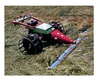
Motofaucheuse avec barre de coupe à doigts: depuis toujours, la solution la plus sûre dans les pentes et la plus protectrice pour le sol!
