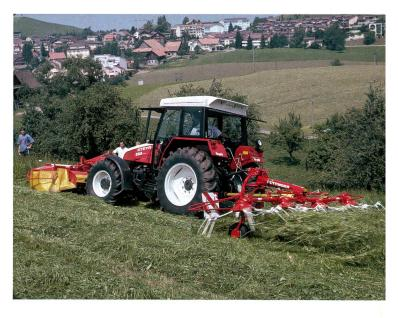
Le conditionnement avec la pirouette derrière la faucheuse frontale permet un travail rationnel mais n'est à recommander que lorsque les végétaux et le sol sont bien secs.
