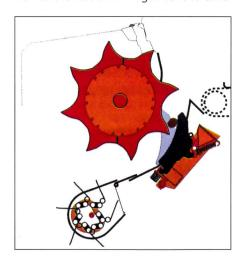
Fig. 7: Rotor convoyeur avec huit rangées de dents non guidées. Le rendement de chargement élevé et la possibilité de le combiner avec un grand nombre de couteaux disposés sur un seul niveau rendent ce système de chargement particulièrement intéressant pour les autochargeuses-ensileuses (source: Pöttinger).
