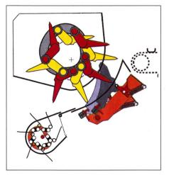
Fig. 5: Convoyeur oscillant à quatre rangées de dents séparé avec dents guidées. Etant donné son caractère multifonctionnel, le convoyeur oscillant est le système de chargement le plus répandu (source: Pöttinger).
