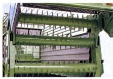
Fig. 10: Les autochargeuses-doseuses équipées de trois rouleaux augmentent le volume de chargement utile. De plus, elles déchargent plus régulièrement ce qui est particulièrement avantageux pour le foin (source: Deutz-Fahr).
