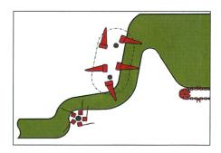
Fig. 4: Chaîne de râteau avec cing éléments de convoyage. Le convoyeur à râteaux permet de ménager le fourrage, avantage intéressant surtout lorsqu'il s'agit de charger de l'herbe fraîche et du foin (source: GVS-Agrar).
