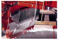
Fig. 9: Les barres de couteaux escamotables à la main ou à l'aide d'un dispositif hydraulique permettent d'éliminer les bourrages au niveau du dispositif de coupe et facilitent l'accès aux couteaux pour les besoins de la maintenance (source: Mengele).
