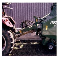
Fig. 11: En cas d'alimentation des siloscouloirs avec la remorgue d'ensilage, celle-ci doit être équipée d'un timon hydraulique pour pouvoir circuler sans problème dans les silos-couloirs.
