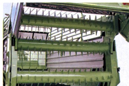
Fig. 10: Les autochargeuses-doseuses équipées de trois rouleaux augmentent le volume de chargement utile. De plus, elles déchargent plus régulièrement ce qui est particulièrement avantageux pour le foin (source: Deutz-Fahr).
