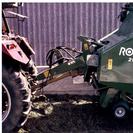
Fig. 11: En cas d'alimentation des silos-couloirs avec la remorque d'ensilage, celle-ci doit être équipée d'un timon hydraulique pour pouvoir circuler sans problème dans les silos-couloirs.
