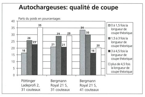
Fig. 14: Comparaison de la qualité de coupe de l'ensilage préfané (33 % MS) sur deux autochargeuses-ensileuses (Bergmann Royal 21 S et Pöttinger Ladeprofi 2) avec un nombre de couteaux similaire et maximum.
