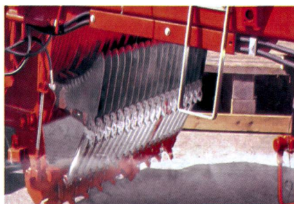
Fig. 9: Les barres de couteaux escamotables à la main ou à l'aide d'un dispositif hydraulique permettent d'éliminer les brouillages au niveau du dispositif de coupe et facilitent l'accès aux couteaux pour les besoins de la maintenance (source: Mengele).
