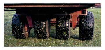
Fig. 2: L'essieu oscillant double est la solution la plus avantageuse pour les exploitations herbagères qui récoltent l'herbe chaque jour, car il ménage le sol et la couche herbeuse.
