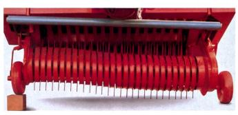
Fig. 3: Lorsque la largeur de ramassage est importante, les pickup devraient être à torsion flexible pour mieux s'adapter aux sols et éviter de trop souiller le fourrage (source: Mengele).
