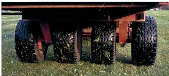
Fig. 2: L'essieu oscillant double est la solution la plus avantageuse pour les exploitations herbagères qui récoltent l'herbe chaque jour, car il ménage le sol et la couche herbeuse.
