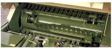
Fig. 6: Le convoyeur oscillant décalé sur le côté est censé réduire le nombre de pointes par rapport aux convoyeur continu et permettre ainsi un chargement plus régulier (source: Krone).
