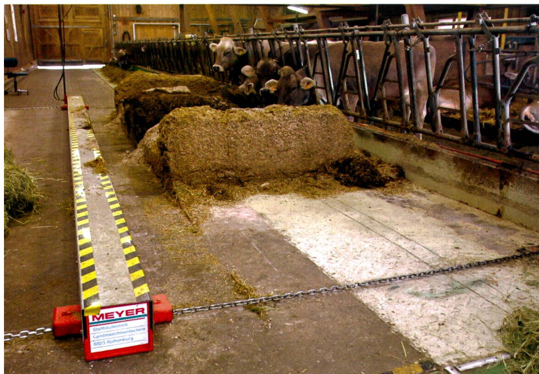
Le pousse-fourrage est actionné par un moteur électrique ou hydraulique.
