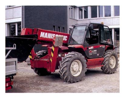
Ce lourd chariot télescopique de chantier dépasse de par sa construction, le porte-à-faux avant (véhicule industriel: 3 m, véhicule agricole: 4 m) et sera immatriculé comme véhicule exceptionnel avec plaque brun clair.
