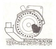
Organe de mise en place pneumatique – principe d'aspiration
