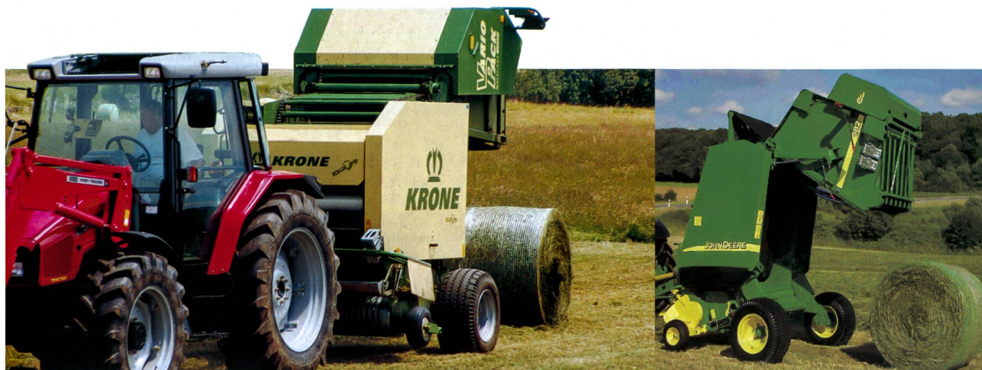
A gauche: la presse Vario Pack 1800 Multi Cut de Krone travaille avec des chaînes à tiges. Le dispositif de coupe compte 17 couteaux au maximum et le diamètre des balles varie de 1,0 à 1,8 m. A droite: la presse John Deere 590 est le modèle JD à chambre variable. Les balles se forment au moyen de bandes qui les entourent. Les diamètres des balles vont de 0,6 à 1,8 m.
