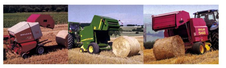
A gauche: la presse Welger RP 220 MASTER Proficut est une presse à chambre fixe équipée de 18 rouleaux de pressage. Le dispositif de coupe comprend au maximum 23 couteaux. Au milieu: la presse John Deere 575 est le modèle JD à chambre fixe comprenant 17 rouleaux de pressage. Le diamètre des balles s'élève à 1,25 m. Le nombre maximum de couteaux est de 14. A droite: la presse New Holland 548 Crop Cutter est une presse à chambre fixe avec chaîne à tige et 15 couteaux au maximum.
