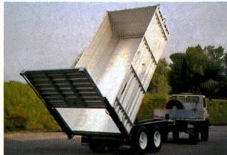
Grâce au développement et au montage d'une porte arrière hydraulique, un voeu de la clientèle Marolf a été réalisé.
