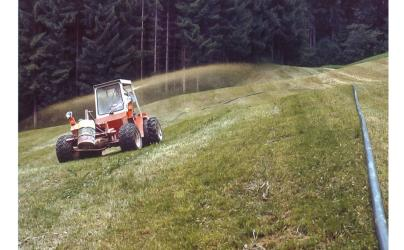
Non seulement fiable dans les pentes, le purinage par tuyau ménage le sol et offre des rendements élevés sur des exploitations aux parcelles regroupées.
