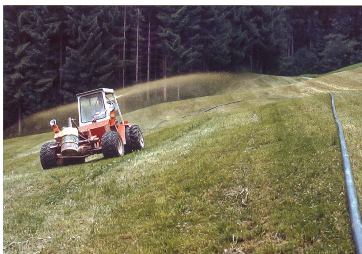
Non seulement fiable dans les pentes, le purinage par tuyau ménage le sol et offre des rendements élevés sur des exploitations aux parcelles regroupées.
