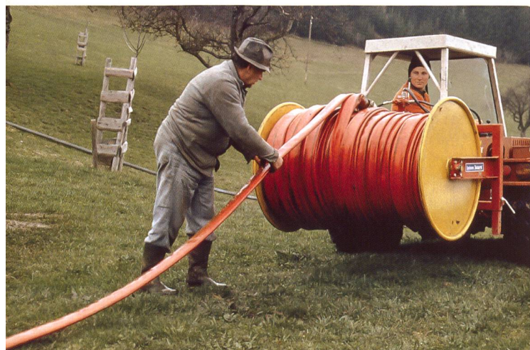
On gagne de la place en enroulant les tuyaux souples sur un dévidoir attelé au système trois-point. De plus, la fiabilité en pente est assez bonne.
