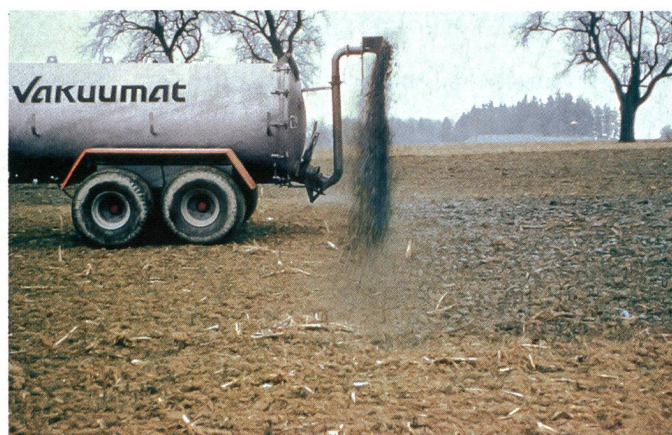
Les répartiteurs verticaux ont une portée d'épandage légèrement plus large que les déflecteurs conventionnels; ils permettent aussi un purinage exact au début et à la fin du champ.
