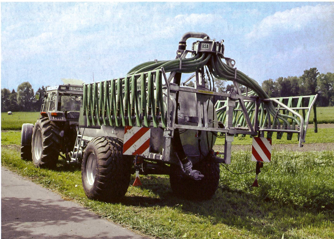
Une citerne équipée d'une rampe d'épandage est classée, selon l'OETV comme «Remorque de transport avec appareil supplémentaire» et peut donc dépasser la largeur maximale de 2,55 m jusqu'à la largeur du véhicule tracteur (au maximum 3 m).
