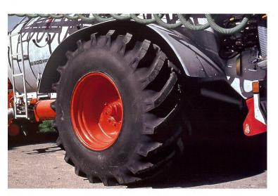
Grâce à des roues encastrées, il est possible d'équiper les grandes citernes de pneus ménageant le sol sans dépasser la largeur maximale autorisée.
