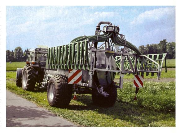
Une citerne équipée d'une rampe d'épandage est classée, selon l'OETV comme «Remorque de transport avec appareil supplémentaire» et peut donc dépasser la largeur maximale de 2,55 m jusqu'à la largeur du véhicule tracteur (au maximum 3 m).
